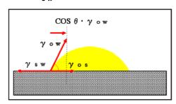
水/固体基質の界面張力を ws、油/固体基質の界面張力を os、油/水の界面張力を ow とすると、次式が成立します。
